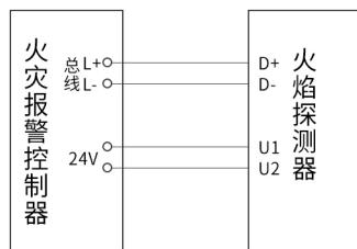
警告! 请待探测器安装完毕, 接线无误后再接通电源。
