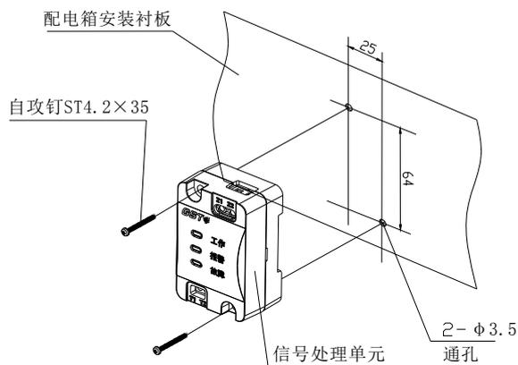
图 2.39 信号处理单元螺钉固定安装图
