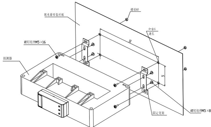
图 2.7 闭口方孔型 (DH-GSTN5100/12F、DH-GSTN5100/22F) 探测器安装过程分解图
