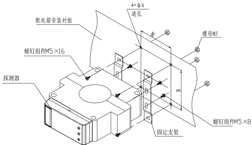
图 2.10 开口圆孔型探测器安装过程分解图
