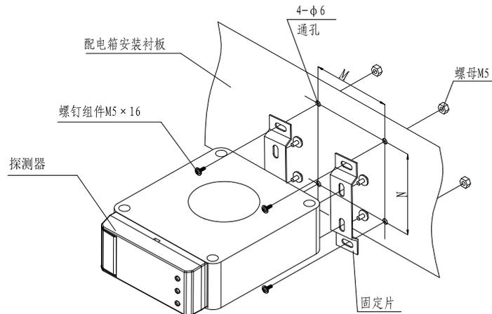
图 2.6 闭口圆孔型探测器安装过程分解图
