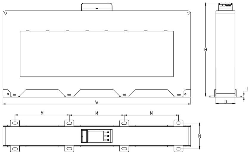
图 2.4 闭口方孔型 (DH-GSTN5100/50F) 探测器外形示意图
