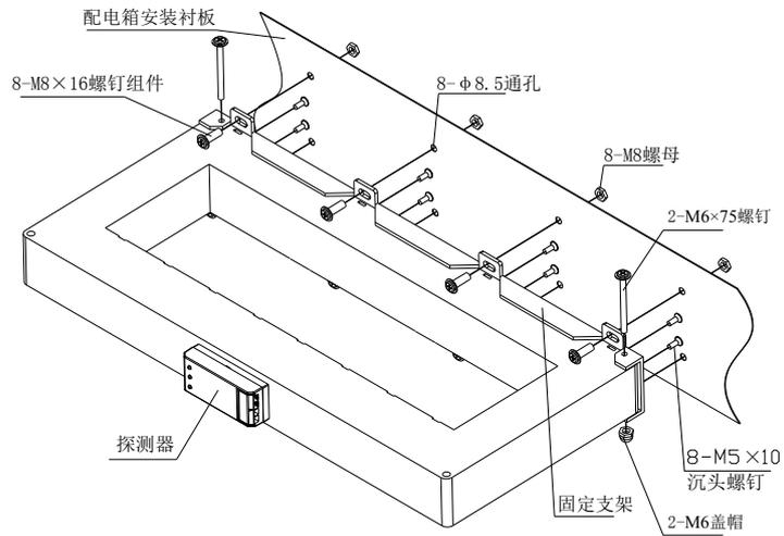
图 2.9 闭口方孔型 (DH-GSTN5100/50F) 探测器安装过程分解图
