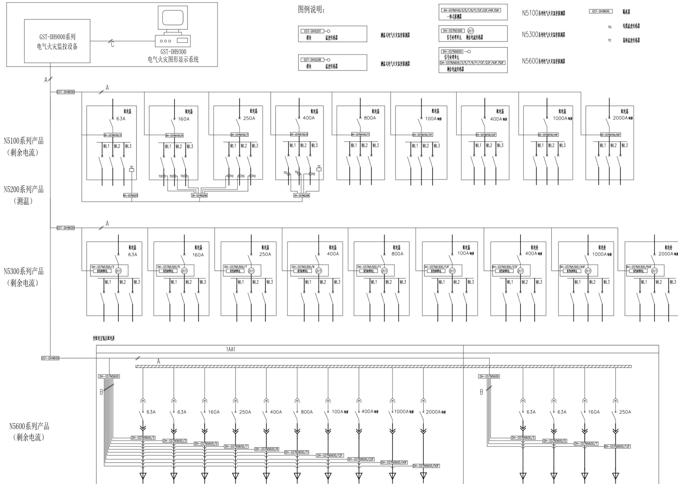
图 4.1 GST 电气火灾监控系统示意
