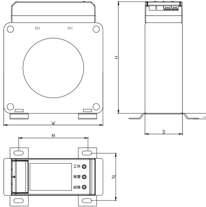
图 2.1 闭口圆孔型探测器外形示意图
