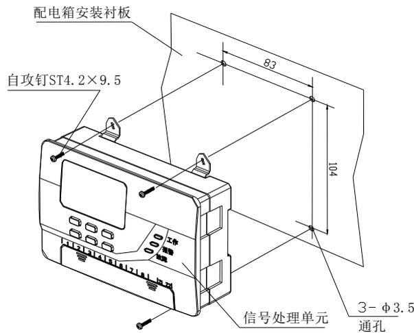
图 2.44 信号处理单元螺钉固定安装图（壁挂式）
