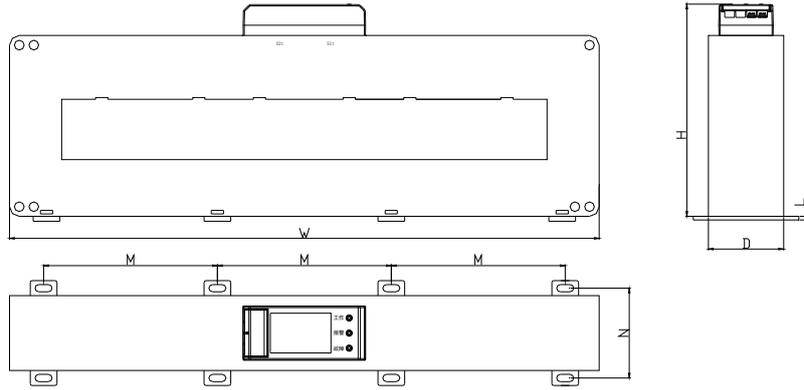
图 2.3 闭口方孔型 (DH-GSTN5100/40F) 探测器外形示意图
