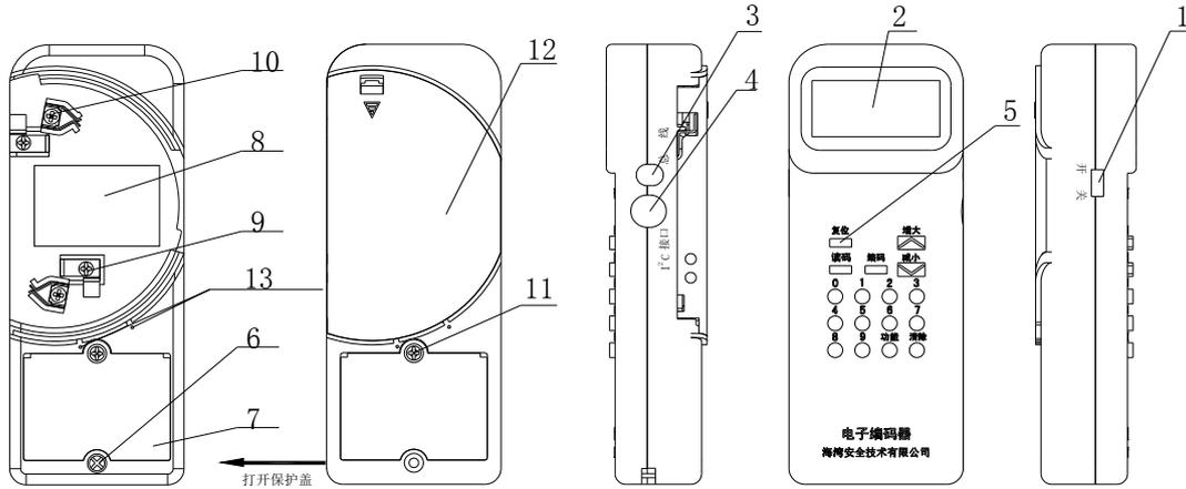
图 2.51 电子编码器外形示意图
