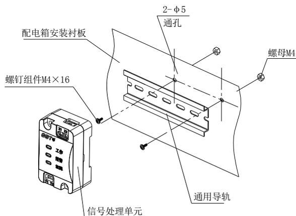
图 2.40 信息处理单元导轨安装图
