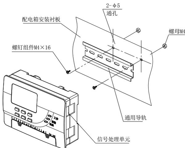
图 2.45 信号处理单元导轨安装图
