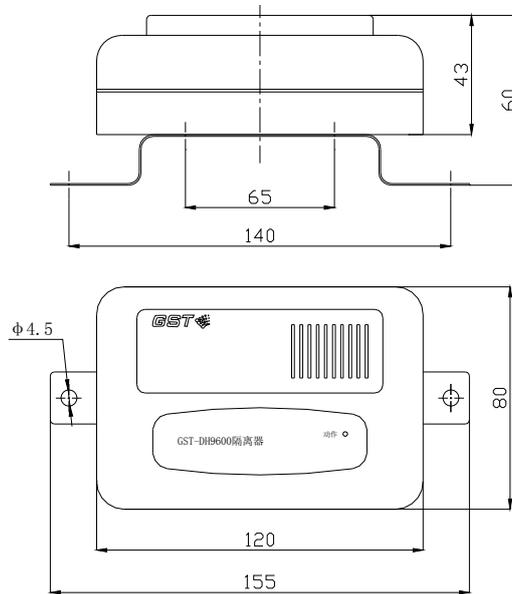
图 2.48 GST-DH9600 隔离器外形示意图
