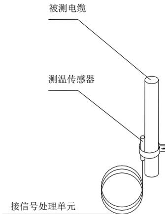
图 2.41 温度传感器安装过程分解图
