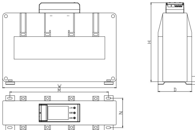
图 2.2 闭口方孔型探测器外形示意图
