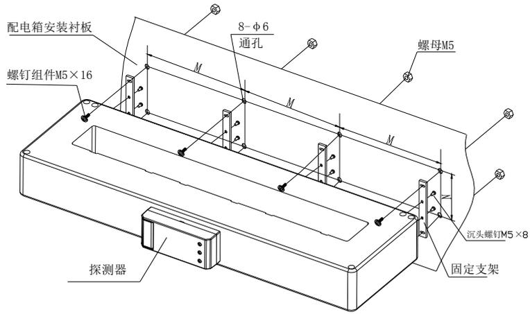
图 2.8 闭口方孔型 (DH-GSTN5100/40F) 探测器安装过程分解图
