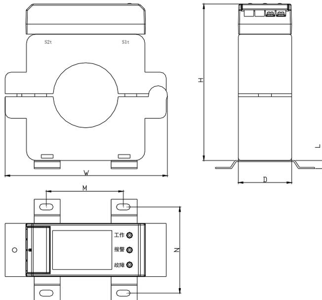
图 2.5 开口圆孔型探测器外形示意图
