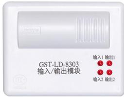
GST-LD-8303 输入/输出模块是一种总线制控制接口，可用于完成对二步降防火卷帘门、水泵、排烟风机等双动作设备的控制。主要用于防火卷帘门的位置控制，能控制其从上位到中位，也能控制其从中位到下位，同时也能确认防火卷帘门是处于上、中、下的哪一位。该模块也可作为两个独立的 GST-LD-8301A 输入/输出模块使用。
