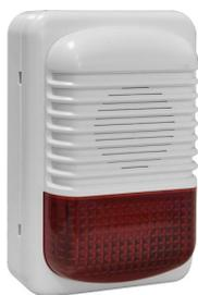
GST-HX-321B/W 火灾声光报警器为编码型产品，用于在火灾发生时提醒现场人员注意，当现场发生火灾并被确认后，可由消防控制中心的火灾报警控制器启动，启动后报警器发出强烈的声光信号，以达到提醒现场人员注意的目的。报警器是一种安装在现场的防水声光报警设备，抗磷化铝、盐雾、二氧化硫腐蚀，可用于非住宅室内及管廊、隧道等，也适用于仓库、厂房，及其它有磷化铝、盐雾、二氧化硫腐蚀环境的场所。有磷化氢熏蒸测试报告。主要有以下特点：
