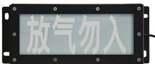
GST-LD-8317H/W 气体释放警报器（以下简称警报器）是气体灭火系统的配套产品，通常安装在被保护场所的入口处。当气体喷洒后，气体灭火控制器（以下简称控制器）将启动警报器发出灯光指示，提醒人员注意并采取相应的措施。本警报器为编码型，与控制器进行通信采用数字信号，工作稳定可靠，对电磁干扰有良好的抑制能力。地址码为电子编码，可由电子编码器事先写入，也可由控制器直接改写，工程调试简便。
