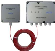
JTW-LD-GST85B 缆式线型感温火灾探测器是由缆式线型感温火灾探测器信号处理单元、缆式线型感温火灾探测器终端盒以及感温电缆三部分共同组成。产品安装方便，运行稳定，符合 GB 16280-2014 标准相关要求。本探测器为编码型，可与公司火灾报警控制器配套使用，也可以作为独立式探测器
