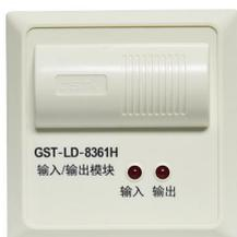
GST-LD-8361H 输入/输出模块，主要用于连接需要火灾报警控制器控制的消防联动设备，主要应用两种情形：1) 被控设备控制端口提供 12V~48V 检线电压的场合，如卷帘门、消防电梯等；2) 需要 DC24V 有源控制（持续输出）的场合，如电磁阀、非编码声光等，并可接收设备的动作回答信号。
