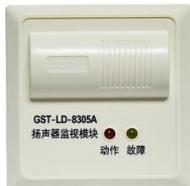
GST-LD-8305A 扬声器监视模块（以下简称模块），用于总线制消防广播系统中正常广播和消防广播间的切换。模块在切换到消防广播后自回答，并将切换信息传回火灾报警控制器，以表明切换成功。模块采用 32 位 ARM 微处理器实现信号处理，用数字信号与控制器进行通信，工作稳定可靠，对电磁干扰有良好的抑制能力。总线和消防广播系统隔离，检线抗干扰能力强。
