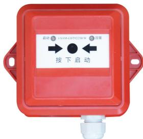
J-SAM-GST9223B/W 消火栓按钮(以下简称消火栓按钮)表面装一按片,当启用消火栓时,可直接按下按片,此时消火栓按钮的红色启动指示灯亮,表明已向消防控制室发出了报警信息,火灾报警控制器在确认了消防水泵已启动运行后,就向消火栓按钮发出命令信号点亮绿色回答指示灯。本消火栓按钮满足 IP67 防护等级,适用于管廊等场所。
