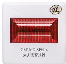
GST-MD-M9514 火灾光警报器用于显示室内火灾探测器报警情况。一般安装在巡视观察方便的地方，如会议室、餐厅、房间等门口上方，当房间内探测器报警时，警报器上的指示灯根据警报器设置的设备类型可以自动闪亮，也可以通过控制器联动启动闪亮，使工作人员在不进入室内的情况下就可知道室内的探测器已触发报警。GST-MD-M9514 火灾光警报器为编码型警报器，可直接接入火灾报警控制器的信号二总线。
