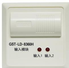
GST-LD-8360H 输入模块，用于接收消防联动设备输入的常开或常闭开关量信号，并将联动信息传回火灾报警控制器（联动型）。主要用于配接现场各种主动型设备如水流指示器、压力开关、位置开关、信号阀及能够送回开关信号的外部联动设备等。这些设备动作后，输出的动作信号可由模块通过信号二总线送入火灾报警控制器，产生报警，并可通过火灾报警控制器来联动其它相关设备动作。
