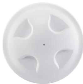
在非编码火灾自动报警系统中，传统方式都是通过回路终端连接一只电阻来维持系统的正常工作，一旦匹配不当将使整个报警系统工作不正常，甚至会产生误报警等问题。GST-LD-8320A 终端器与 GST-LD-8319 输入模块配套使用，取代了终端电阻，当报警系统输出回路中有现场设备被取下时，GST-LD-8319 输入模块可向控制器报出故障，但不影响其它现场设备正常工作。有效地解决了上述问题，大大提高了非编码报警系统的可靠性。
