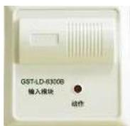
GST-LD-8300B 输入模块，用于接收消防联动设备输入的常开或常闭开关量信号，并将联动信息传回火灾报警控制器（联动型）。主要用于配接现场各种主动型设备如水流指示器、压力开关、位置开关、信号阀及能够送回开关信号的外部联动设备等。这些设备动作后，输出的动作信号可由模块通过信号二总线送入火灾报警控制器，产生报警，并可通过火灾报警控制器来联动其它相关设备动作。
