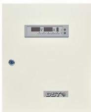
GST-DY-200H 智能电源箱是一种 DC24V 大容量电源输出设备，在火灾报警控制系统中，可作为联动控制系统的电源使用，为联动控制模块及被控设备供电。电源箱以交流 220V 作为主电源，同时内置 DC24V/10Ah 密封铅酸电池作为备用电源。采用开关电源稳压电路及备电浮充电路，具有输出过流自动保护、主备电切换和完善的备电自动充电及备电过放电保护功能。同时，本智能电源箱可对主、备电及电源输出状态进行监控，可报主、备电故障、输出故障，还具有输出电压、输出电流的显示功能，可直观地观察电源箱的工作状态。
