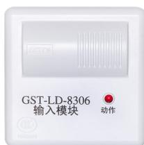
GST-LD-8306 型输入模块用于配接各种类型的防盗探测器，可为防盗探测器提供 DC12V/100mA 电源，与感烟、感温等火灾探测器共同组成防火、防盗综合报警系统。输入模块设有信号输入端，用于和防盗探测器的开关量无源输出触点连接，可将防盗探测器的动作信息传回火灾报警控制器。输入方式可设为常开检线、常闭检线。考虑到防盗探测器功耗较高，在实际使用时，输入模块除与火灾报警控制器的信号二总线连接外，另需接二根 DC24V 电源线。
