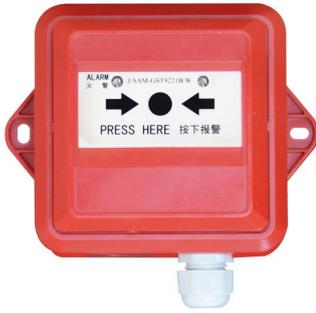
J-SAM-GST9221B/W 手动火灾报警按钮（以下简称报警按钮）安装在公共场所，当人工确认火灾发生后按下报警按钮上的按片，可向控制器发出火灾报警信号，控制器接收到报警信号后，显示出报警按钮的编码信息并发出报警声响。满足国标 GB 19880-2005《手动火灾报警按钮》的有关规定。本报警按钮满足 IP67 防护等级，适用于管廊等场所。本按钮主要具
