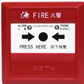
J-SAM-GST9122B 手动火灾报警按钮/消防电话插孔（以下简称报警按钮）安装在公共场所，本报警按钮含消防电话插孔。当人工确认发生火灾后，按下报警按钮上的按片，即可向控制器发出报警信号，控制器接收到报警信号后，将显示出报警按钮的编码信息并发出报警声响，将消防电话分机插入电话插孔即可与电话主机通讯。本手动
