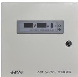
GST-DY-050H 电源箱是专门用来为消防系统供电的 DC24V 现场电源输出设备。具有输出噪声小、稳定性强及安装使用方便等特点，具有主备电自动切换、备电充电、备电保护功能。主备电自动切换保证了在主电掉电情况下，系统仍然能够正常工作；完善的备电充电功能和备电保护功能，可确保蓄电池的循环使用。电源箱输出电流为 2A。
