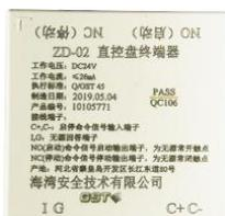
ZD-02 直控盘终端器（以下简称终端器），主要用于重要设备的启动、停动控制。与具有断路、短路检测功能的 GST-LD-KZ08H 直控盘配合使用。提供一组常开触点、一组常闭触点，使直控盘与被控设备电气隔离，实现启停控制、向直控盘提供反馈信号，终端器本身提供对外接线，便于现场接线。
