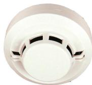
复合探测技术是目前国际上流行的新型多功能高可靠性的火灾探测技术。JTF-GOM-GST601T 型点型光电感烟火灾探测器、点型感温火灾探测器（简称点型复合式感烟感温火灾探测器）是由烟雾传感器件和半导体温度传感器件从工艺结构和电路结构上共同构成的多元复合探测器。它不仅具有普通散射型光电感烟火灾探测器的性能，而且兼有定温、差定温感温火灾探测器的性能。正是由于感烟与感温的复合技术，使得该款复合探测器能够对国家标准试验火 SH3（聚氨酯塑料火）和 SH4（正庚烷火）的燃烧进行探测和报警。同时该款探测器也能对酒精燃烧等有明显温升的明火探测报警，扩大了光电感烟探测器的应用范围。
