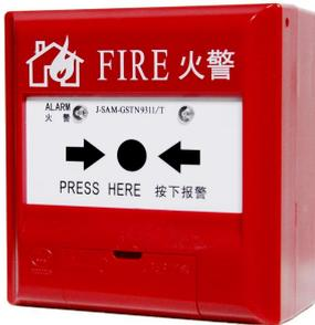
J-SAM-GSTN9311/T 手动火灾报警按钮（以下简称报警按钮）安装在公共场所，当人工确认火灾发生后按下报警按钮上的按片，可向控制器发出火灾报警信号，控制器接收到报警信号后，显示出报警按钮的编码信息并发出报警声响。满足国标 GB 19880-2005《手动火灾报警按钮》的有关规定。本报警按钮抗磷化铝（氢）、盐雾、二氧化硫腐蚀，适用于仓库、厂房及其它有磷化铝（氢）、盐雾、二氧化硫腐蚀环境的场所。有磷化氢熏蒸测试报告。
