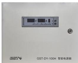
GST-DY-100H 智能电源箱是一种 DC24V 大容量电源输出设备，在火灾报警控制系统中，可作为联动控制系统的电源使用，为联动控制模块及被控设备供电。电源箱以交流 220V 作为主电源，同时内置 DC24V/7Ah 密封铅酸电池作为备用电源，采用开关电源稳压电路及备电浮充电路，具有输出过流自动保护、主备电切换和完善的备电自动充电及备电过放电保护功能。同时，本智能电源箱可对主、备电及电源输出状态进行监控，可报主、备电故障、输出故障，还具有输出电压、输出电流的显示功能，可直观地观察电源箱的工作状态。
