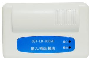
GST-LD-8362H 输入/输出模块，主要用于控制 AC220V 的消防联动设备，如照明切电、消防水泵、风机等，并可接收设备的动作回答信号。采用 32 位 ARM 微处理器实现信号处理，用数字信号与控制器进行通信，工作稳定可靠，对电磁干扰有良好的抑制能力。
