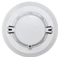
JTF-GOM-G5C 点型复合式感烟感温火灾探测器(简称探测器)是由烟雾传感器件和半导体温度传感器件从工艺结构和电路结构上共同构成的多元复合探测器。由于感烟与感温的复合技术,使得该款复合探测器能够对国家标准试验火 SH3(聚氨酯塑料火)和 SH4(正庚烷火)的燃烧进行探测和报警。同时该款探测器也能对酒精燃烧等有明显温升的明火探测报警,扩大了光电感烟探测器的应用范围。本探测器具有以下特点:
