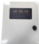
PSU24-10 防水型电源箱是一种 DC24V 大容量电源输出设备，在火灾报警控制系统中，可作为联动控制系统的电源使用，为联动控制模块及被控设备供电。电源箱以交流 220V 作为主电源，同时内置 DC24V/9Ah 密封铅酸电池作为备用电源。市电交流输入经过电源模块转换成 24V 直流电源为蓄电池充电及为负载供电；电源系统为蓄电池提供恒压恒流充电，即当蓄电池电量未充满时，系统采用恒流充电，蓄电池充满电后输出电压转换为恒压模式；系统内的 CPU 可以监测显示直流输出电压、输出电流、充电电流。交流市电及电源工作正常时，电源为蓄电池充电和为输出负载供电。当出现交流掉电或电源变换器故障时，备用电源自动导入为外部设备供电，主备电真正实现无间隙切换。
