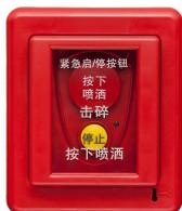
GST-LD-8318 紧急启/停按钮，用于控制气体灭火系统的启动及停动。通常安装在现场，当被保护的区域内发生火灾时，按下“按下喷洒”按键，即可向气体灭火控制器（以下简称控制器）发出气体喷洒请求信号。气体灭火控制器发出气体喷洒命令，经延时，启动气体喷洒电磁阀。在延时期间，若现场人员确认无火灾发生，可立即按下“停止”按键，终止启动。
