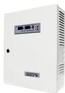
GST-DY-600H 智能电源箱是一种 DC24V 大容量电源输出设备，在火灾报警控制系统中，可作为联动控制系统的电源使用，为联动控制模块及被控设备供电。电源箱以交流 220V 作为主电源，同时内置 DC24V/14Ah 密封铅酸电池作为备用电源。采用开关电源稳压电路及备电浮充电路，具有输出过流自动保护、主备电切换和完善的备电自动充电及备电过放电保护功能。同时，本智能电源箱可对主、备电及电源输出状态进行监控，可报主、备电故障、输出故障，还具有输出电压、输出电流的显示功能，可直观地观察电源箱的工作状态。
