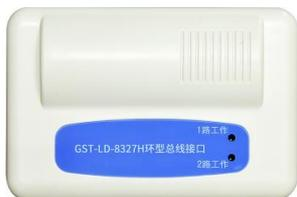
GST-LD-8327 环型总线接口（以下简称接口），主要用于环型总线组网。每个接口可组建 2 个回路，每个回路地址固定为 242。当环型总线出现断路或短路时，接口继电器动作，输入输出总线信号，并向控制器报传动作信息。线路故障排除后需通过控制器复位命令复位接口。
