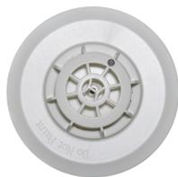
JTW-ZCD-G5H 点型感温火灾探测器（以下简称探测器）为无极性二总线制，可与本公司生产的各类火灾报警控制器的报警总线以任意方式并接。探测器采用带 A/D 转换的单片机。本探测器结构新颖、外形美观、性能稳定可靠，特别适用于发生火灾时有剧烈温升的场所，与感烟探测器配合使用更能可靠探测火灾，减少损失。探测器具有 A1R 和 BS 两种类别，根据应用环境的不同，可使用编码器进行现场设置。本探测器具有以下特点：
