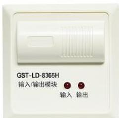
GST-LD-8365H 输入/输出模块(以下简称模块), 主要用于连接需要火灾报警控制器控制的消防联动设备, 主要应用两种情形: 1) 被控设备控制端口提供 12V~48V 检线电压的场合, 如卷帘门、消防电梯等; 2) 需要外接 DC24V 有源控制(持续输出)的场合, 如电磁阀、非编码声光等, 并可接收设备的动作回答信号。模块两线制低功耗设计, 采用 32 位 ARM 微处理器实现信号处理, 用数字信号与控制器进行通信, 工作稳定可靠, 对电磁干扰有良好抑制能力, 输入、输出均具有检线功能, 输入信号隔离检测, 抗干扰能力强, 输出触点容量 2A, 可采用电子编码器现场完成编码设置。
