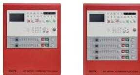
GST-QKP02H、GST-QKP04H 火灾报警控制器/气体灭火控制器（简称为 QKPH）是海湾公司为适应工程设计的需要而开发的。QKPH 为典型的气体灭火控制装置，可配接感烟/感温/火焰探测器、手动报警按钮、紧急启/停按钮、声光警报器、气体喷洒指示灯、手自动转换开关以及输出模块等，具有火灾探测和气体灭火控制功能，可实现 2~4 个防火区的火灾报警和气体灭火控制。
