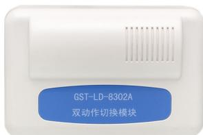
GST-LD-8302A 型双动作切换模块是一种专门设计用于与 GST-LD-8303 输入/输出模块连接，实现控制器与被控设备之间作交流直流隔离及启动、停动双动作控制的接口部件。
