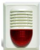
GST-HX-240B 火灾声光报警器(以下简称报警器),用于在火灾发生时提醒现场人员注意。报警器是一种安装在现场的声光报警设备,当现场发生火灾并被确认后,可由消防控制中心的火灾报警控制器启动。启动后报警器发出强烈的声光信号,以达到提醒现场人员注意的目的。
