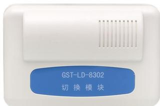
GST-LD-8302 型切换模块专门用来与 GST-LD-8301A 型模块配合使用,实现对现场大电流(直流)启动设备的控制及交流 220V 设备的转换控制,以防由于使用 GST-LD-8301A 型模块直接控制设备造成将交流电源引入控制系统总线的危险。
