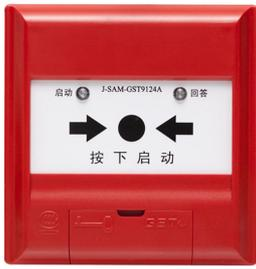
J-SAM-GST9124A 消火栓按钮通常安装在消火栓箱内，当人工确认发生火灾后，按下此按钮，即可启动消防水泵，同时向火灾报警控制器发出报警信号，火灾报警控制器接收到报警信号，将显示出按钮的编码号，并发出报警声响。本按钮采用三线制与设备连接，可完成对设备的启动及泵回答信号的监视功能，断开与火灾报警控制器连接的信号总线仍可正常启泵、检测回答信号和点亮指示灯。本按钮主要具有以下特点：
