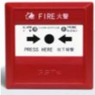
J-SAM-GST9121C 手动火灾报警按钮（以下简称报警按钮）安装在公共场所，当人工确认火灾发生后按下报警按钮上的按片，可向控制器发出火灾报警信号，控制器接收到报警信号后，显示出报警按钮的编码信息并发出报警声响。本手动火灾报警按钮主要具有以下特点：
