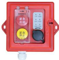
GST-LD-8316/W 手自动转换装置（以下简称转换装置），用于控制气体灭火系统在手动状态和自动状态之间的转换，同时还有紧急启动和停动功能。通常安装在保护区门口便于操作的位置，当有人员进入被保护区域时，可通过转换装置将系统置于手动模式，以禁止系统的联动启动；当无人员在被保护区域时，可通过转换装置将系统置于自动模式，以便火灾报警系统能自动联动气体灭火。当被保护的区域内发生火灾时，按下“紧急启动”按键，即可向气体灭火控制器发出气体喷洒请求信号，气体灭火控制器按预设逻辑开始启动声光报警、关闭空调风阀等，经延时后，启动气体喷洒电磁阀。在延时期间，若现场人员确认无火灾发生或现场有人没有撤离，可立即按下“紧急停止”按键，中止延时。转换开关为编码方式，占一个编码点；转换开关同时具有系统手自动转换功能和紧急启、停功能。
