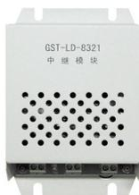
GST-LD-8321 中继模块采用 DC24V 供电，总线信号输入与输出间电气隔离，完成了探测器总线的信号隔离传输，可增强整个系统的抗干扰能力，并且具有扩展探测器总线通讯距离的功能。GST-LD-8321 中继模块主要用于总线处在有比较强的电磁干扰的区域及总线长度超过 1000m 需要延长总线通讯距离的场合。
