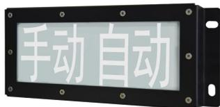
GST-LD-8335H/W 手动自动状态指示灯（以下简称指示灯）是气体灭火系统的配套产品，用来指示气体灭火系统在手动状态和自动状态之间的转换。通常安装在防护区域内的明显位置，以提醒现场人员保护区内的实时状态，本指示灯为编码型，可与公司气体灭火控制器配套使用。
