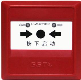
J-SAM-GST9123B 消火栓按钮(以下简称消火栓按钮)表面装一按片,当启用消火栓时,可直接按下按片,此时消火栓按钮的红色启动指示灯亮,表明已向消防控制室发出了报警信息,火灾报警控制器在确认了消防水泵已启动运行后,就向消火栓按钮发出命令信号点亮绿色回答指示灯。本按钮主要具有以下特点:
