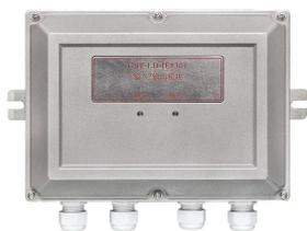
GST-LD-IE8301 输入/输出模块，是一款功能强大、应用广泛的编码工业模块。模块可以通过设置不同的工作模式，实现下列功能：启动消防联动设备，如排烟阀、送风阀、防火阀等，同时接收设备的动作回答信号。模块不能用于气体灭火设备的控制。模块符合 GB 16806-2006 中的相关规定。主要具有以下特点：
