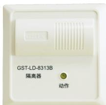
GST-LD-8313B 隔离器主要用于隔离总线上发生短路的部分，保证总线上的其它设备正常工作。待故障修复后，总线隔离器可将被隔离出去的部分重新纳入系统。并且使用隔离器便于确定总线发生短路的位置。采用 32 位 ARM 微处理器实现信号处理，用数字信号与控制器进行通信，工作稳定可靠，对电磁干扰有良好的抑制能力，输入、输出信号无极性。隔离器端口采用电压检测，产品性能更可靠。
