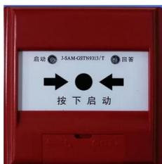
J-SAM-GSTN9313/T消火栓按钮为编码型产品，表面装一按片，当启用消火栓时，可直接按下按片，此时消火栓按钮的红色启动指示灯亮，表明已向消防控制室发出了报警信息，火灾报警控制器在确认了消防水泵已启动运行后，就向消火栓按钮发出命令信号点亮绿色回答指示灯。按钮抗磷化铝（氢）、盐雾、二氧化硫腐蚀，适用于仓库、厂房，及其它有磷化铝（氢）、盐雾、二氧化硫腐蚀环境的场所。有磷化氢熏蒸测试报告。
