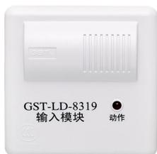
GST-LD-8319 输入模块是一种编码模块，用于连接非编码探测器，只占用一个编码点，当接入模块输出回路的任何一只现场设备报警后，模块都会将报警信息传给火灾报警控制器，火灾报警控制器产生报警信号并显示出模块的地址编号。本模块可配接本公司生产的非编码点型光电感烟火灾探测器、非编码点型感温火灾探测器、非编码点型复合式感烟感温火灾探测器等。模块输出回路最多可连接 15 只非编码现场设备，多种探测器可以混用。GST-LD-8319 输入模块主要具有以下特点：
