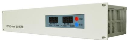
GST-LD-D06H 型智能电源盘由交直流转换电路、备用电源浮充控制电路及电源监控电路三个部分组成，专门为整个消防联动控制系统供电。GST-LD-D06H 型智能电源盘以交流 220V 作为主电源，同时可外接 DC24V/24Ah 蓄电池作为备电。备用电源正常时接受主电源充电，当现场交流掉电时，备用电源自动导入为外部设备供电。智能电源盘可对主电故障及输出故障进行报警，当交流输入掉电时，报主电故障；当输出电压跌落时，报输出故障；同时还设有电池过充及过放保护功能。电源监控部分用来指示当前输出的电压值及输出电流值，并具有备电容量指示，以及各类故障及状态显示。
