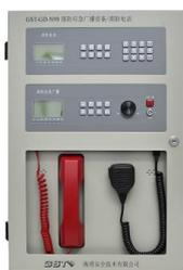
GST-GD-N90 消防应急广播设备是消防应急广播系统的配套产品，完全满足《GB16806-2006 消防联动控制系统》标准的要求。GST-GD-N90 消防应急广播设备集音源和 120W 功率放大电路为一体，与广播终端设备一起组成消防应急广播系统，内置存储芯片可以存储 10 个小时以上的话筒录音，在消防控制器的控制下，共同完成消防联动控制，通过 CAN 总线与控制器进行通信。具有应急广播、话筒、MP3、外线四种播音模式，可手动、自动转换，有硬件锁设置权限保护，可插 FAT32 分区格式 SD 卡，作为 MP3 放音的音源，可实现对电源主、备电状态的智能监控，确保使用的安全性与可靠性，可实时监测当前扬声器数量变化，并对线路短路、断路情况做报警提示。
