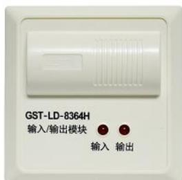
GST-LD-8364H 输入/输出模块，总线供电，主要用于专门应用在需要 DC24V 有源控制（脉冲输出）的场合，如排烟阀、送风阀、电动防火阀等，可接收并上传设备的反馈回答信号。采用 32 位 ARM 微处理器实现信号处理，用数字信号与控制器进行通信，工作稳定可靠，对电磁干扰有良好的抑制能力，模块为两线制低功耗设计，无需外加 24V 供电，输出端可提供 DC25V 有源脉冲电压、输出触点容量 2A。输入、输出信号隔离检测，抗干扰能力强。可采用电子编码器现场完成编码设置。
