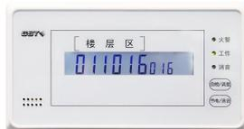
GST-ZF-120Z 火灾显示盘（以下简称火灾显示盘）是一种可用于楼层或独立防火区内的火灾报警显示装置。当建筑物内发生火灾后，消防控制中心的火灾报警控制器产生报警，同时把火警信息传送到火灾显示盘上，火灾显示盘会将报火警的探测器编号及相关信息显示出来并发出声光报警。火灾显示盘通过消防总线与火灾报警控制器相连，火灾报警控制器每个回路可配接 1~242 任意地址点的火灾显示盘。
