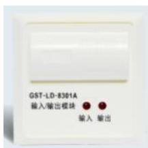
GST-LD-8301A 型输入/输出模块，用于用于连接需要火灾报警控制器控制的消防联动设备，如排烟阀、送风阀、防火阀等，并可接收设备的动作回答信号。采用 32 位 ARM 微处理器实现信号处理，用数字信号与控制器进行通信，工作稳定可靠，对电磁干扰有良好的抑制能力。输入、输出信号隔离检测，抗干扰能力强。可采用电子编码器现场完成编码设置。
