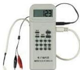
传统的探测器编码需要人工通过机械式拨码设置才能完成，编码效率低，技术要求高，容易出现错码，并且为了方便编码，探测器底部需留出编码口，这样容易造成探测器对粉尘、潮气的密封不良，使探测器的整体性能变差。
