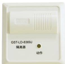
GST-LD-8369J 环型总线隔离器，主要用于隔离总线上发生短路的部分，保证总线上的其它设备正常工作。待故障修复后，总线隔离器可将被隔离出去的部分重新纳入系统。并且使用隔离器便于确定总线发生短路的位置。采用 32 位 ARM 微处理器实现信号处理，用数字信号与控制器进行通信，工作稳定可靠，对电磁干扰有良好的抑制能力，端口采用电压检测，产品性能更可靠。
