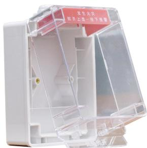
D-92WPB/C 防雨盒外壳防护等级为 IP66，主要用于海湾公司手动报警按钮、消火栓类产品的安装和防护。如 J-SAM-GST9121C 手动火灾报警按钮、J-SAM-GST9122B 手动火灾报警按钮/消防电话插孔、J-SAM-GST9123B 消火栓按钮。防雨盒电缆接头可配接线缆直径范围：6-12mm。
